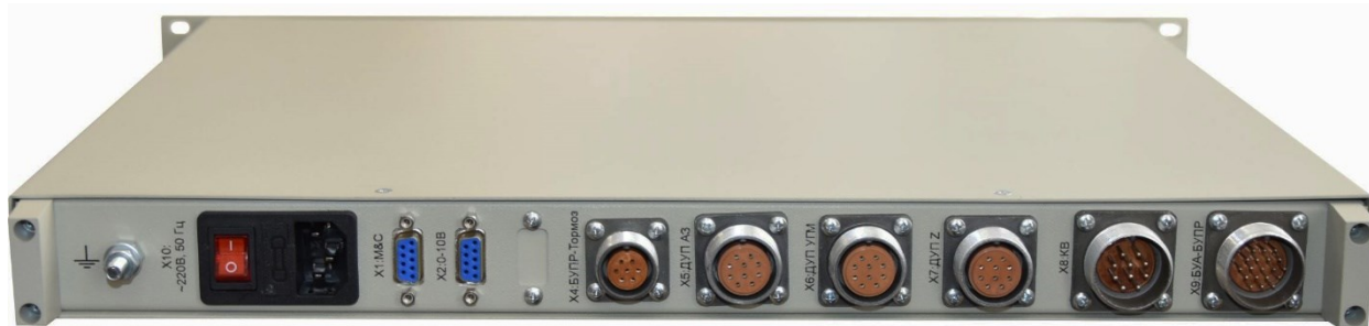
Рисунок 6- Внешний вид задней панели БУА-М Основные параметры БУА-М представлены в таблице 7
